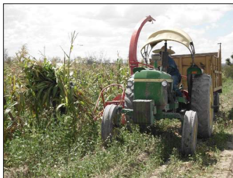
Figura 8. Tractor con ensiladora de un surco y remolque hidráulico.
