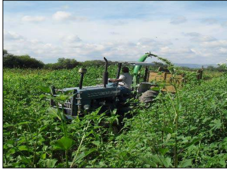
Figura 4. Cosecha y picado de forraje con cosechadora de forraje tipo “chopper”.
