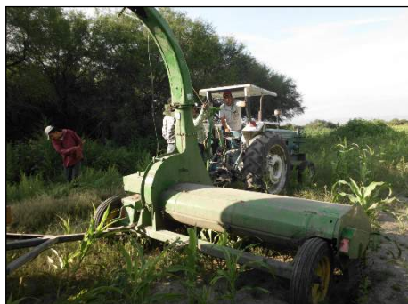
Figura 9. Tractor con cosechadora de forraje tipo “chopper”.
