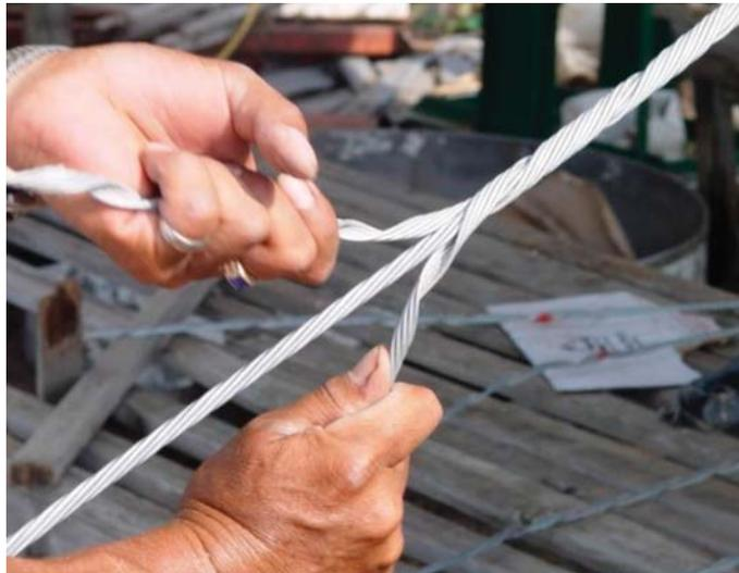
**Figura 4. Colocación correcta de los empalmes.**
