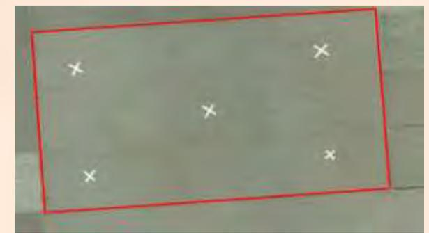
Figura 2. Esquema de división de una superficie homogénea a muestrear y distribución de los puntos de muestreo.
