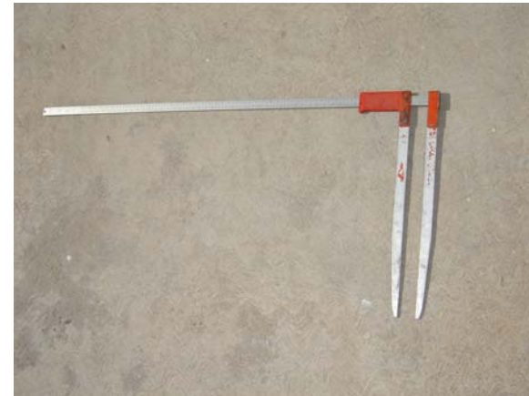
Figura 1. Forcípula de aluminio utilizada para medir el diámetro en piñas de sotol.
