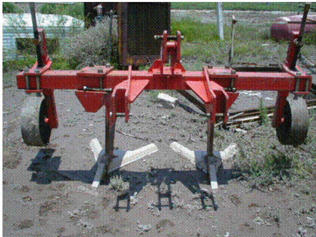
Figura 1. El multiarado es un implemento útil para preparar el suelo en lugar del arado de discos.
