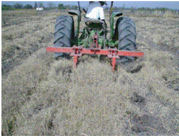
Figura 2. Con el multiarado se puede realizar un control mecánico de la maleza.
