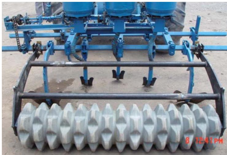
Figura 2. Sistema de Rodillo Aqueel adaptado a una sembradora de frijol en tres hileras.
