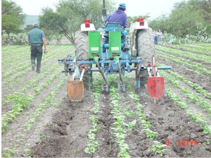
Figura 6. Cultivadora y Pileteadora en un cultivo de frijol.
